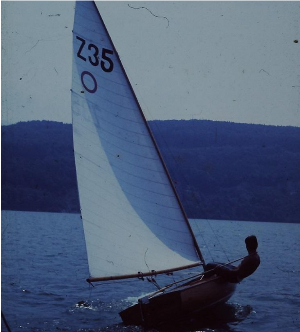
Willi mit der geplankten O-Jolle Lisi mit Holzmast und Baumwollsegel 1968
